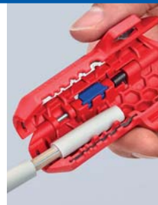
Ontmantelen van een NYM-kabel
