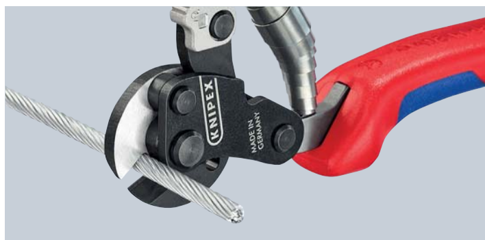
Knippen van zeer stevige draadkabels (1960 N/mm 2 ) tot Ø 4 mm
