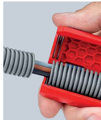
Zuivere snijkant en geen beschadigingen van de binnen liggende kabels, omdat altijd boven op de as gesneden wordt
